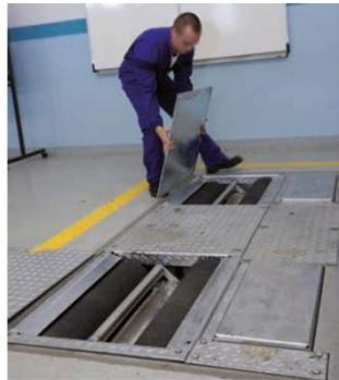
Banc d'essais de freinage muni de protecteurs mobiles
