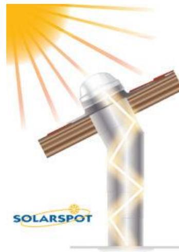
Figure : schéma de puits de lumière
