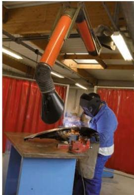
Poste de soudage équipé d'une buse mobile d'aspiration des fumées
