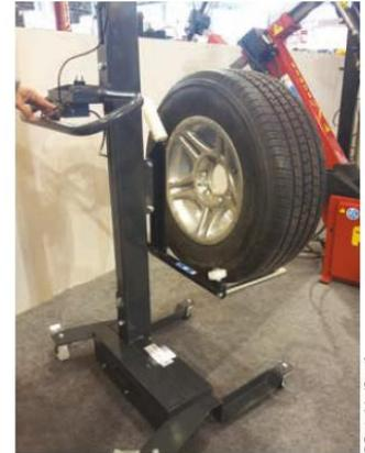
Appareil facilitant la dépose et la manutention des roues dans l'atelier.
