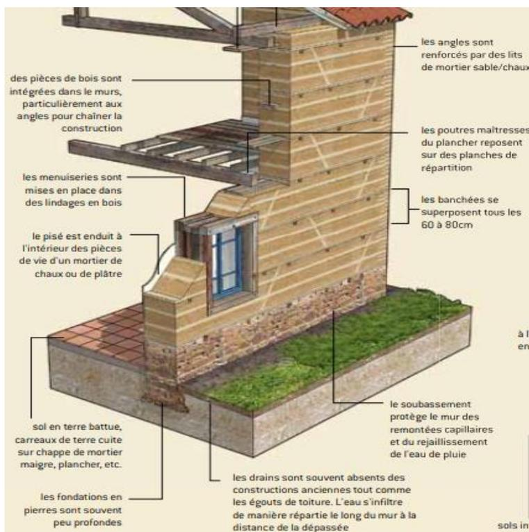
Figure (I.10) : la structure traditionnelle en pisé .
