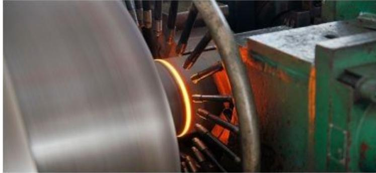
*Figure II.10 : La machine de soudage par friction dans l'atelier [7].*
