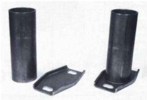
Figure II.16 : Partie d'un amortisseur: tube hydraulique: le soudé à une pièce compressée [9]. tube à double paroi est soudé
