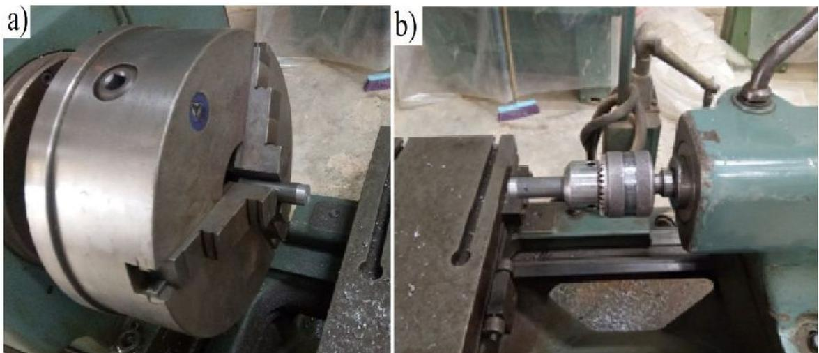
Figure II.7: Mode de fixation des deux pièces. (a) la pièce en rotation au mandrin. (b) la pièce est fixe à la poupée mobile.[6]
