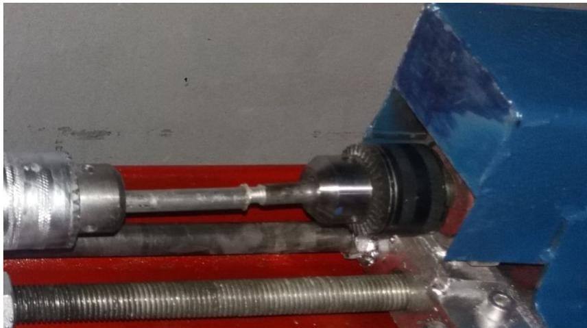
*Figure III. 5 . Fixation des métaux à souder*
