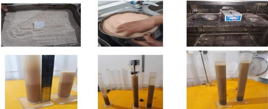
**Figure 6.3 :** Les phases de l'essai d'équivalente de sable
