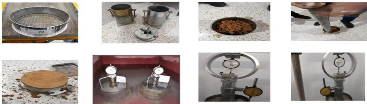
**Figure 6.7 :** les phases de l'essai CBR
