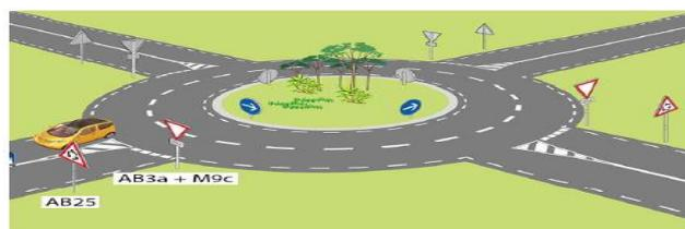
**Figure 9.6 :** Terminologie d'un carrefour giratoire.
