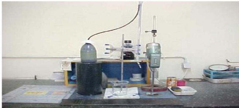
**Figure 6. 5 :**Appareillage de mesure de VBS.
