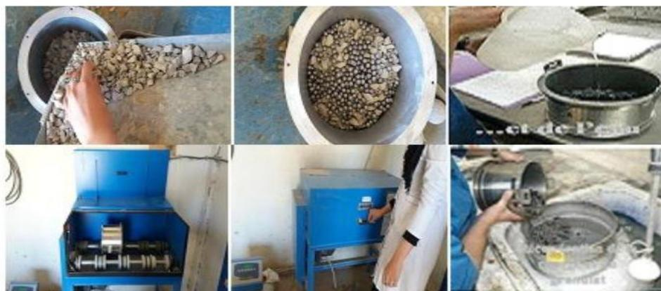
**Figure 6.9:** les phases de l'essai MICRO-DEVAL
