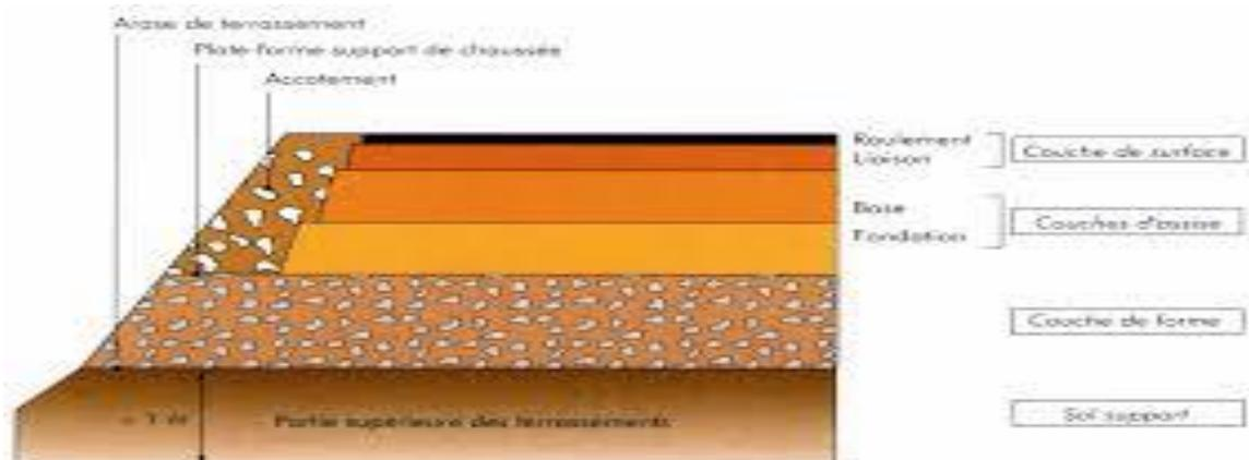
Figure VI .02: terminologie d'une structure de chaussée
