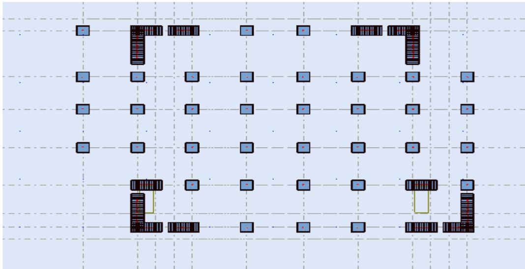
**Fig.V.3. Deuxième disposition des voiles.**
