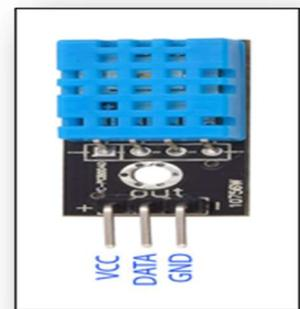
Figure III.13 : capteur dht11
