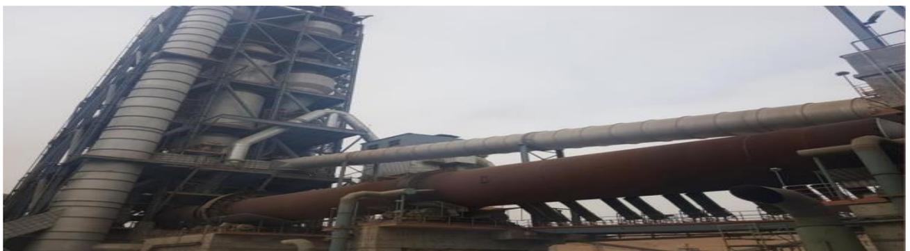
**Figure I.3: Four rotatif de ciment.**
