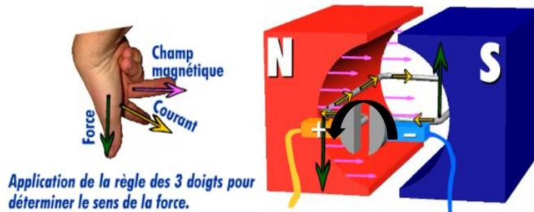
Figure 2.12: Principe de fonctionnement d'un MCC [5]
