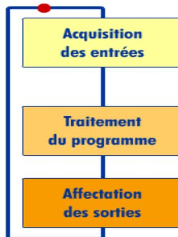
Figure 2.19: Cycle de fonctionnement d'un API
