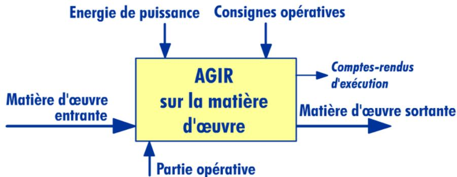
Figure 2.3: Structure de la partie opérative [5]
