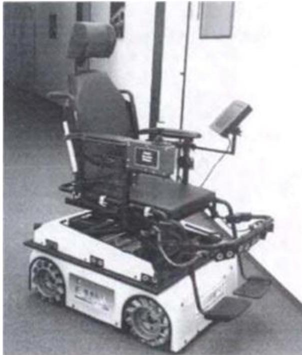
**Figure I-13 :** OMNI, Fauteuil roulant d'omnidirectionnel
