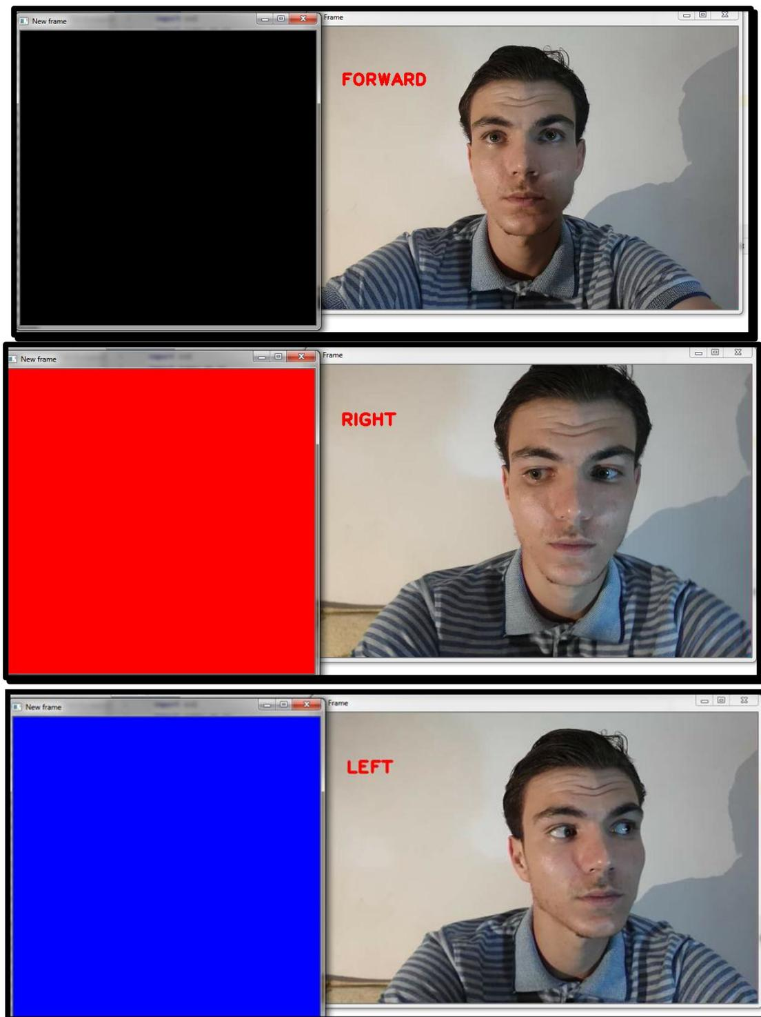
**Figure III-20 :** Résultats de la commande du fauteuil roulant par la direction des yeux
