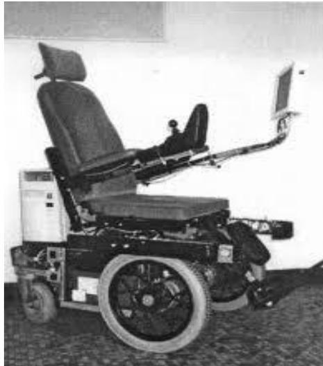
**Figure I-7 :** Le prototype du VAHM
