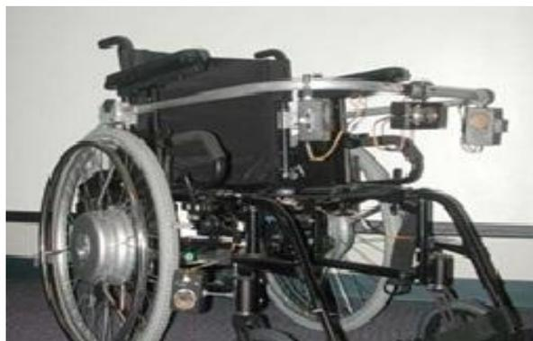
**Figure I-15 :** Le module SPAM placé sur un fauteuil manuel
