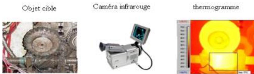
**Fig I.8** Principe de l'analyse thermographique : a) Image visible d'un disjoncteur électrique, b) Visualisation d'un défaut de connexion sur l'image thermique[13].
