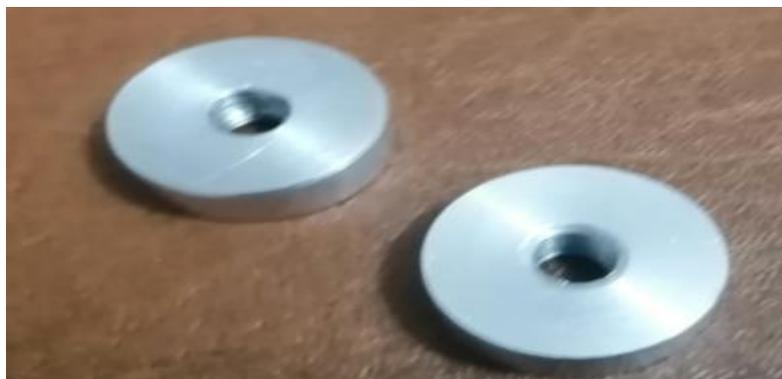
Figure II.12. Ecrou d'axe de guidage.
