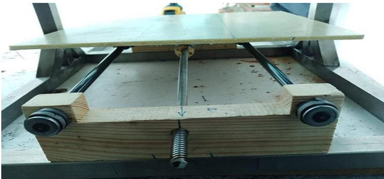
Figure III.6. Fixation de plaque sandwich sur l'axe horizontal.
