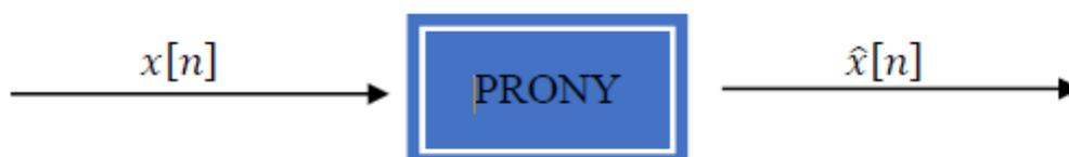
Par exemple, supposons un signal  $x[n]$  de  $N$  échantillons, la méthode de Prony classique rapproche l'ensemble des échantillons à une combinaison linéaire des fonctions exponentielles complexes. Cette combinaison représente l'expression du signal estimé  $\hat{x}[n]$  [SAH 10] :
