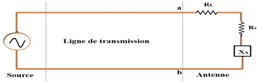
**Figure 1.2 :** Modélisation d'une ligne de transmission
