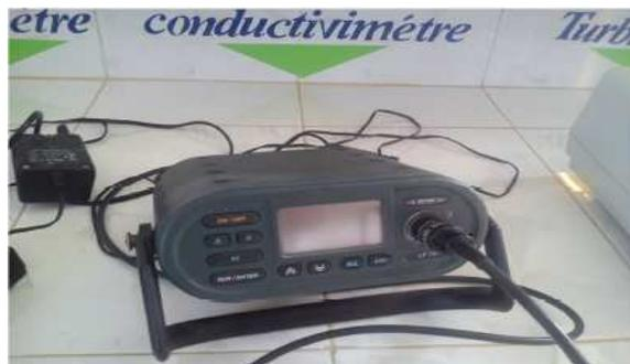
Figure 18: Appareil de conductivité.
