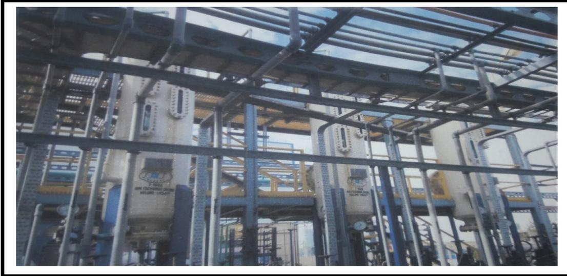
Figure 10 : Unité de filtration par Échanges d'ions.
