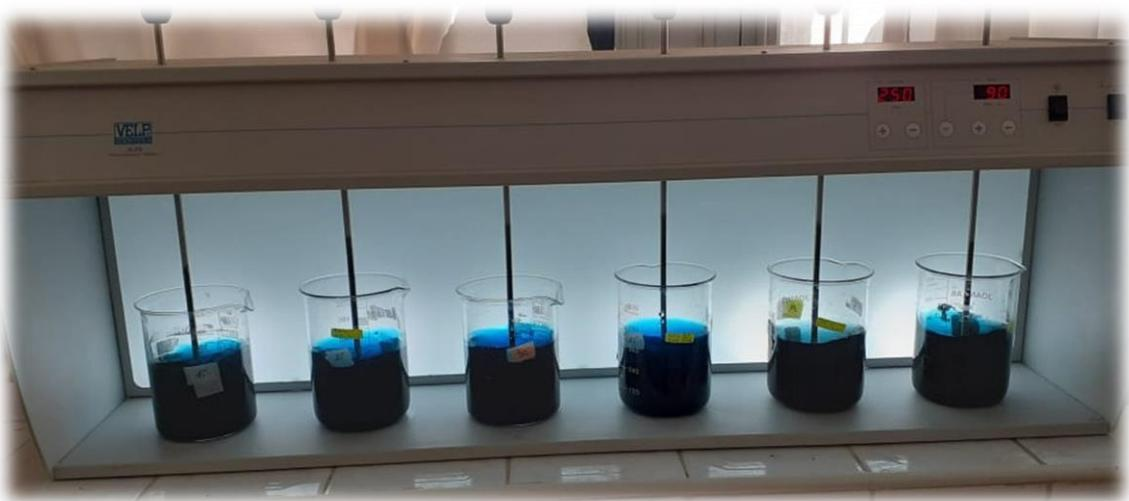
**Figure IV.1 : appareil de jar test**
