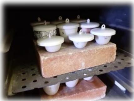
**Figure III.7 :** La carbonisation des noyaux d'olives séchés dans un four à moufle à  $T=500^{\circ}\text{C}$  pendant 4 h
