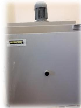
**d-** Le broyage a été réalisé afin d'obtenir des matériaux homogènes, cette opération a été menée en deux étapes : Broyage manuelle des noyaux d'olives carbonisés après on fait le refroidissement suivie par broyage électrique.
