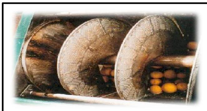
**Figure III.8 :** Expression mécanique à froid
