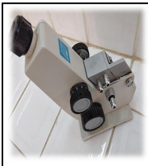
Figure IV. 34 : Réfractomètre
