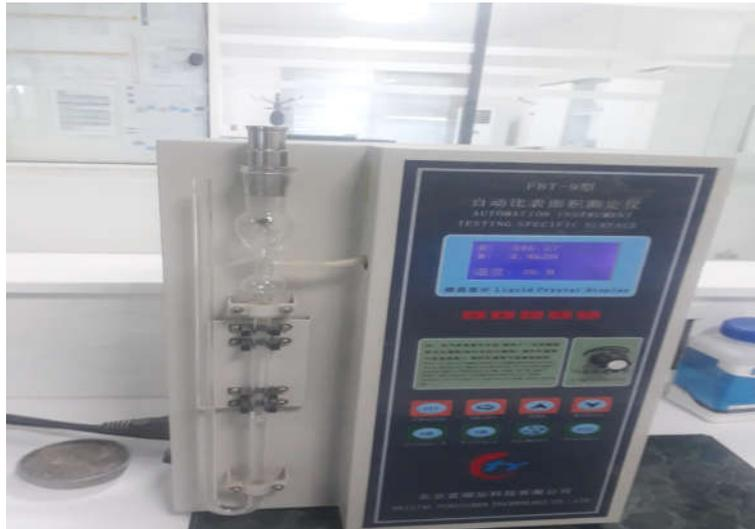
**Figure IV. 9** : Appareil de mesure de SSB
