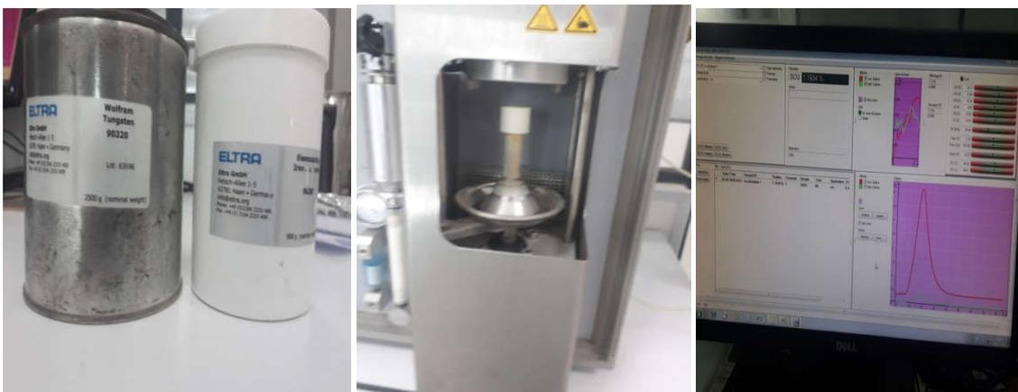
Figure IV.6: Etapes de détermination de pourcentage de  $\text{SO}_3$
