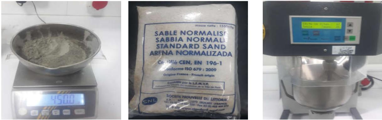
**Figure IV.10 : Préparation du mortier**
