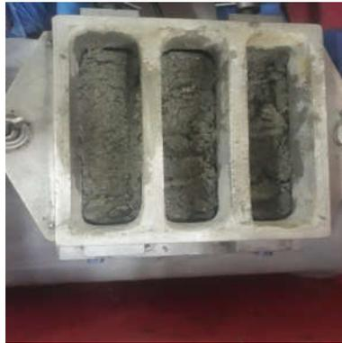
**Figure IV. 11:** Préparation des échantillons pour la mesure de la résistance
