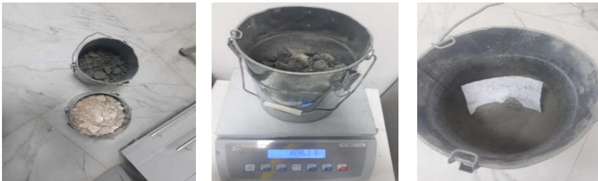
**Figure IV. 8** : Préparation des échantillons
