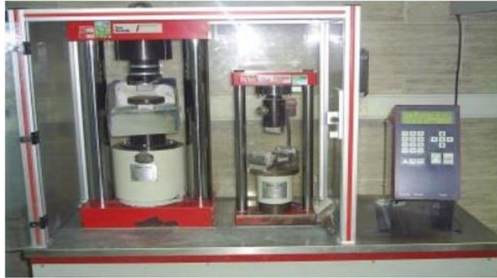
**Figure III.8:** la presse de flexion et compression
