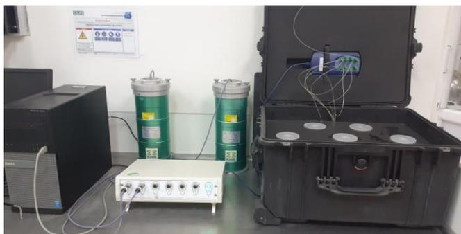
**Figure II.13 :** Appareil de chaleur hydratation
