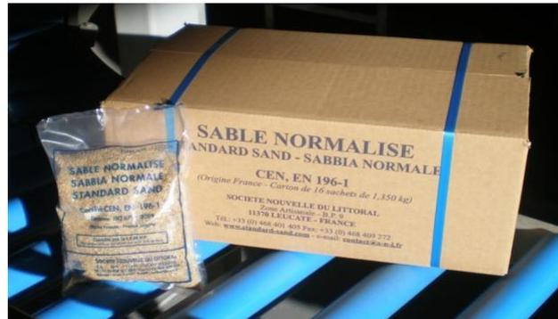
Figure III.1: Sable normalisé
