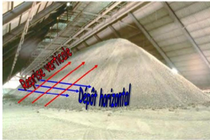
Figure I.11 : La technique de la pré-homogénéisation
