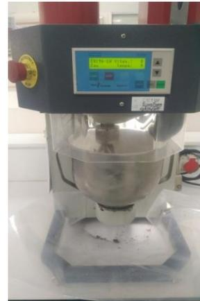
**Figure III.4:** Eprouvette (4x4x16) cm<sup>3</sup>    **Figure III.5:** Malaxeur semi- automatique
