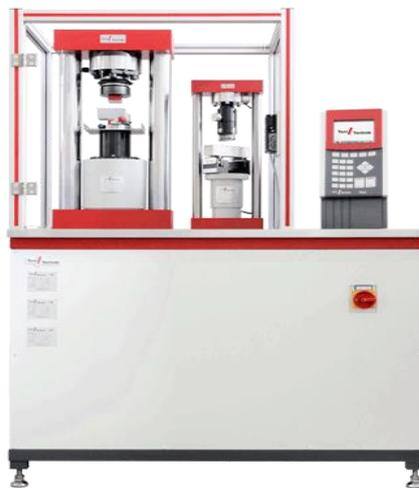
**Figure II.12** : Appareil de flexion et compression
