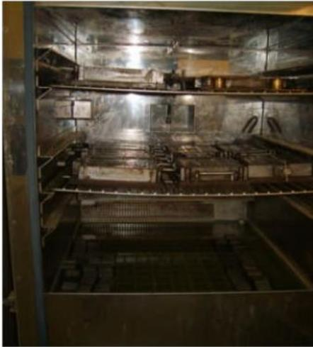
**Figure II.10** : Chambre d'humidité
