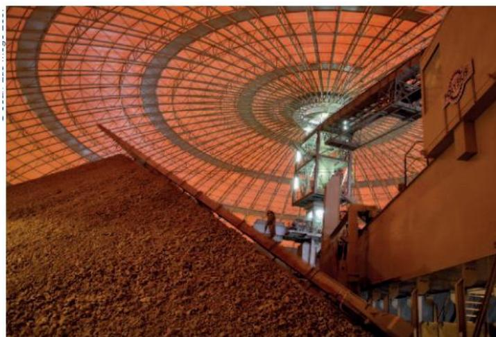
**Figure I.10** : Hall de pré-homogénéisation
