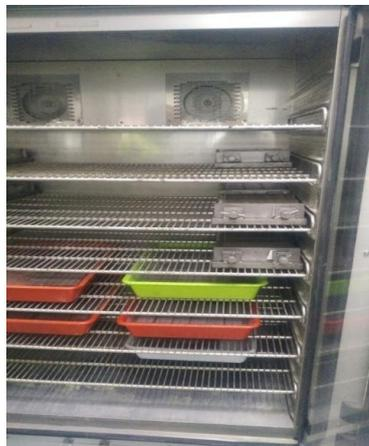
**Figure III.7:** Chambre d'humidité
