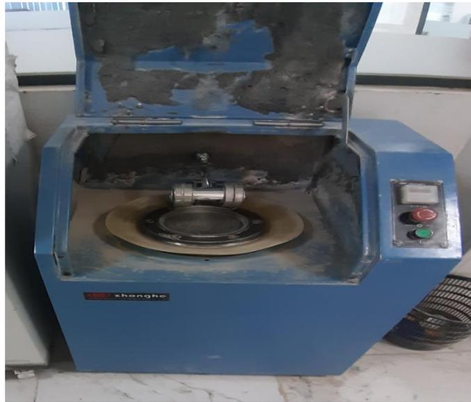
**FigIII.2 :** Broyeur à disque [1]
