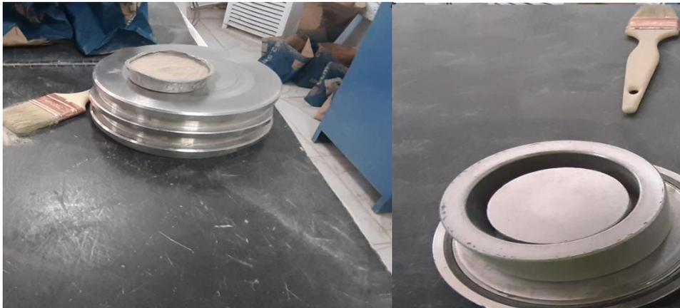
**FigIII.1** : Moule pour le broyage des échantillons [1]
