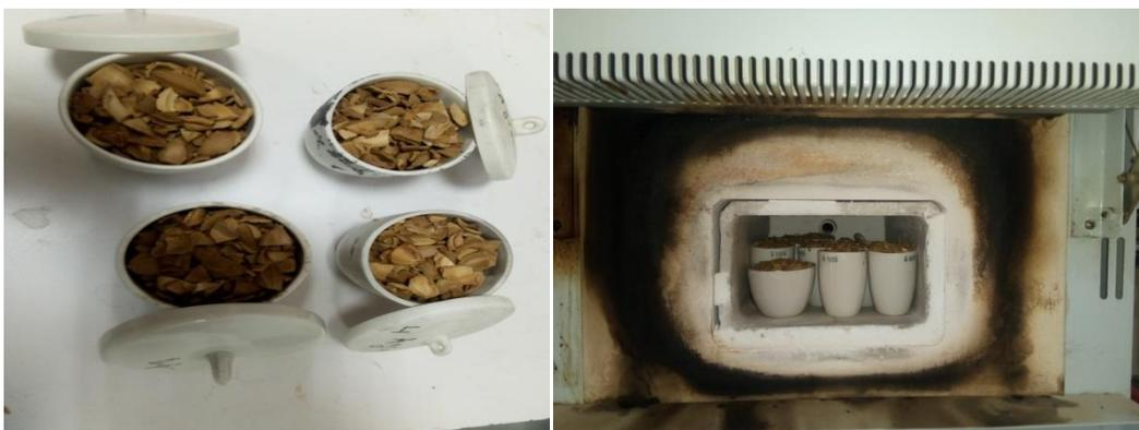
**Figure III.4:**Pré carbonisation coques des noyaux d'abricots
