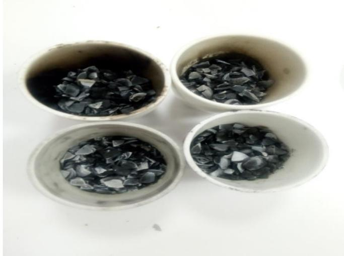
**Figure III.5 :** Refroidissement de coques des noyaux d'abricot carbonisés
