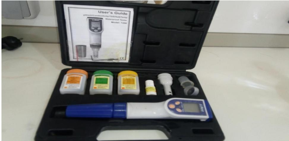
**Figure III.12 :** pH mètre multi paramètre.
