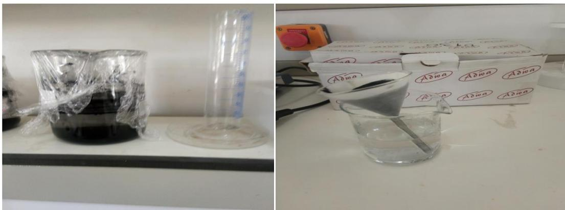
**Figure III.11 :** lavage et filtration de charbon actif.
