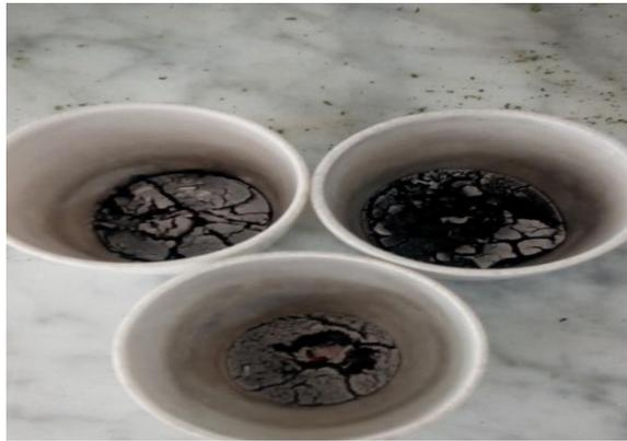
**Figure III.10:** charbon actif des noyaux d'abricots carbonisés
