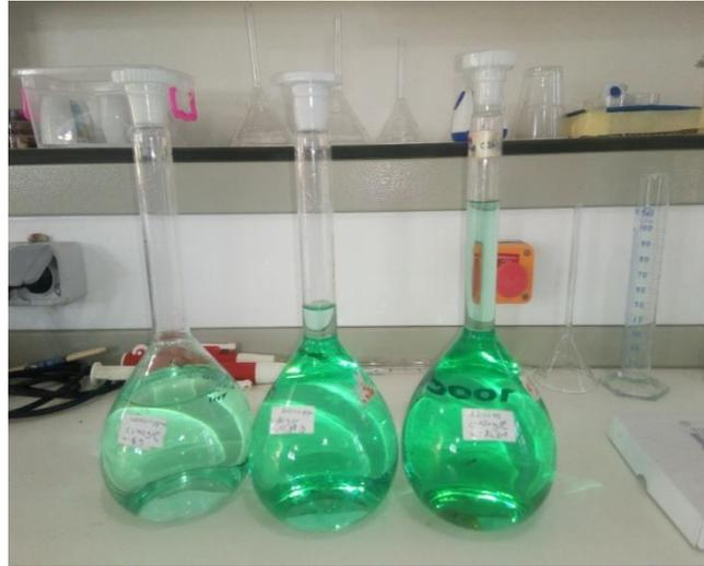
**Figure III.1:** solution mère de Sulfate de nickel( $\text{NiSO}_4$ ) En trois concentrations
