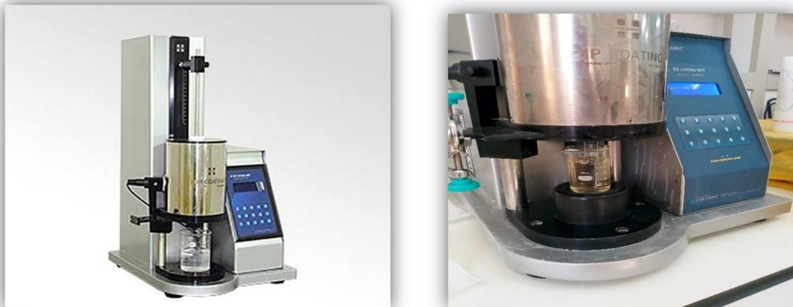
**Figure II. 5:** Un appareil expérimental d'extrusion de films utilisé dans le laboratoire de films et interfaces<sup>1</sup> (La photo de droite provient de l'Université Mohamed Khaider – Biskra).
