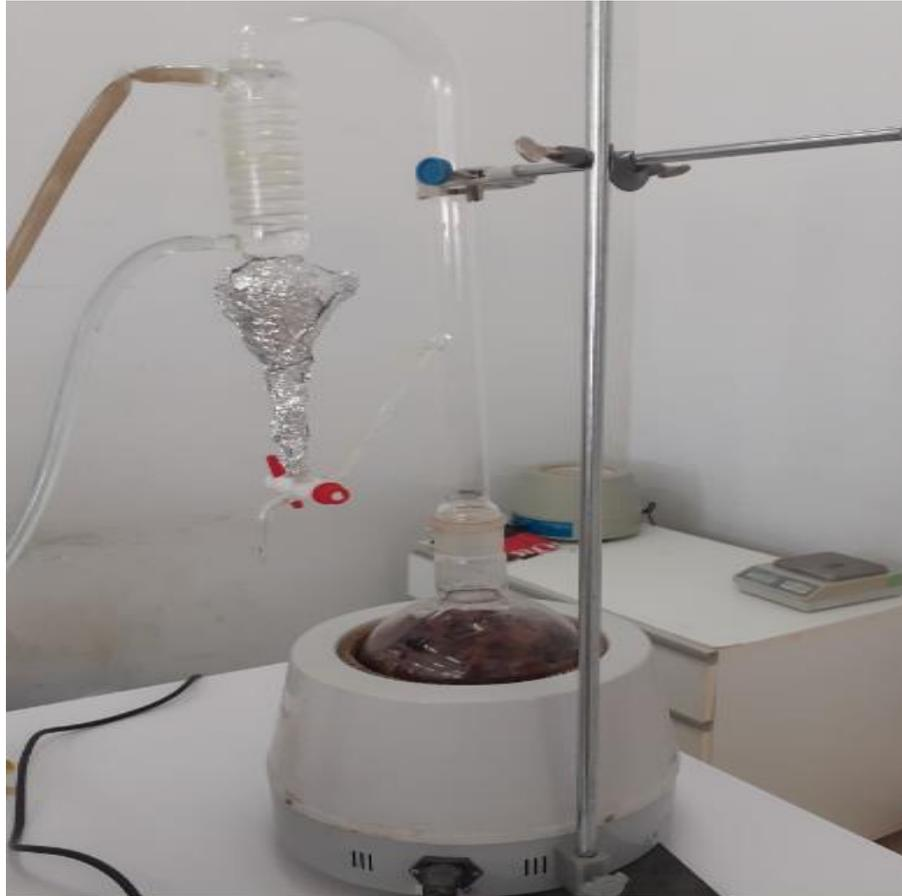
**Figure 2.** Montage de type Clevenger pour l'extraction des huiles essentielles
