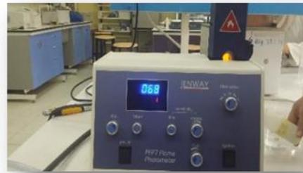
**Figure 13** : Photomètre à flamme
