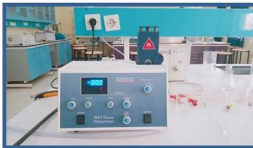
Figure 29: Spectrophotomètre a flamme
