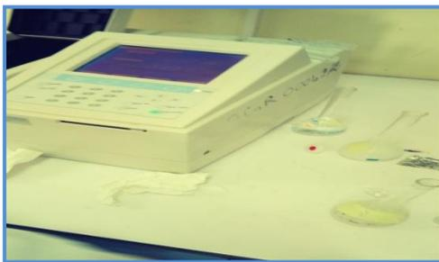
Figure 28: Spectrophotomètre UV-visible
