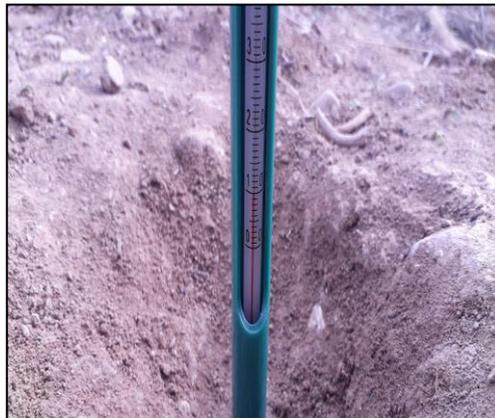
**Figure 15 :** mesure la température avec thermomètre du sol (original)
