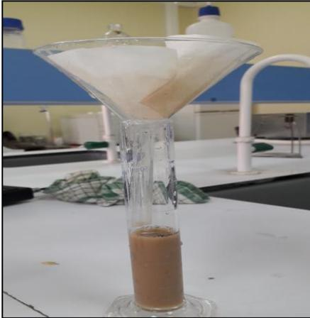
**Figure 13 :** filtration la solution avec papier filtre (original)
