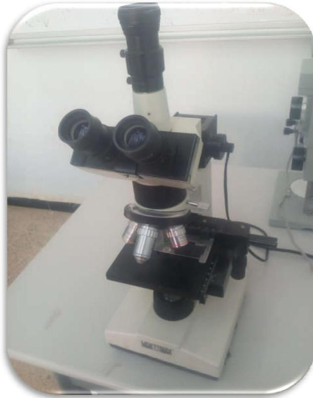
الشكل 11.III. جهاز المجهر الضوئي .
