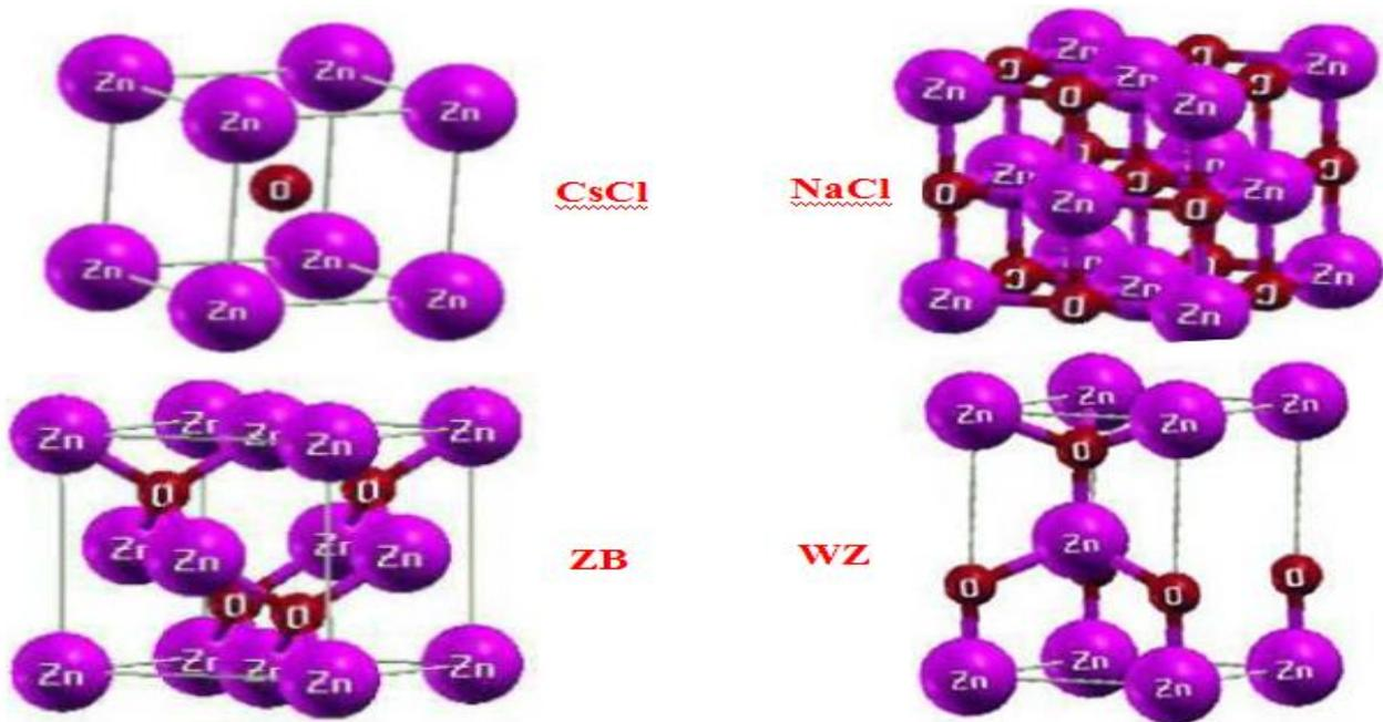
**Figure. IV.5:** Les différentes structures cristallines utilisées dans notre calcul : CsCl, NaCl, zinc-blende (ZB), et Wurtzite (WZ)
