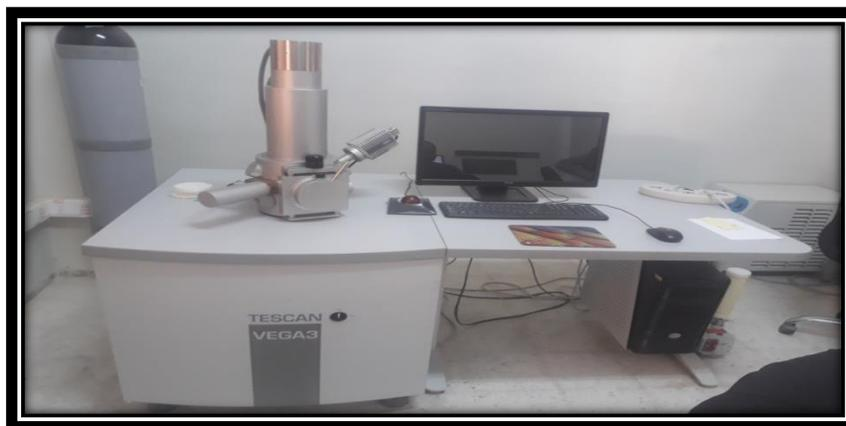
**Figure II.5:** Une microscopie électronique à balayage (MEB) de type TESCAN VEGA3.
