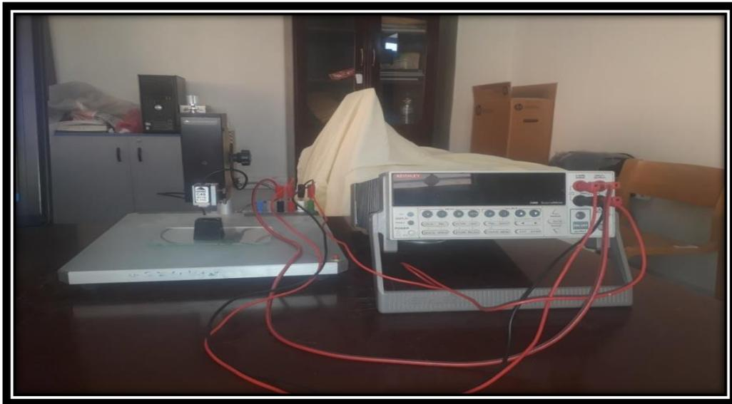
**Figure II.17:** Dispositif de mesure de la conductivité de quatre pointes.
