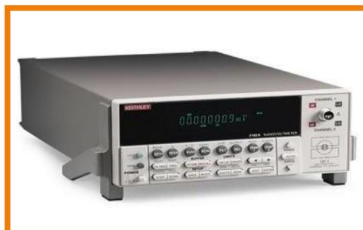
Figure. III.13. Nano-voltmètre Keithley 2182.
