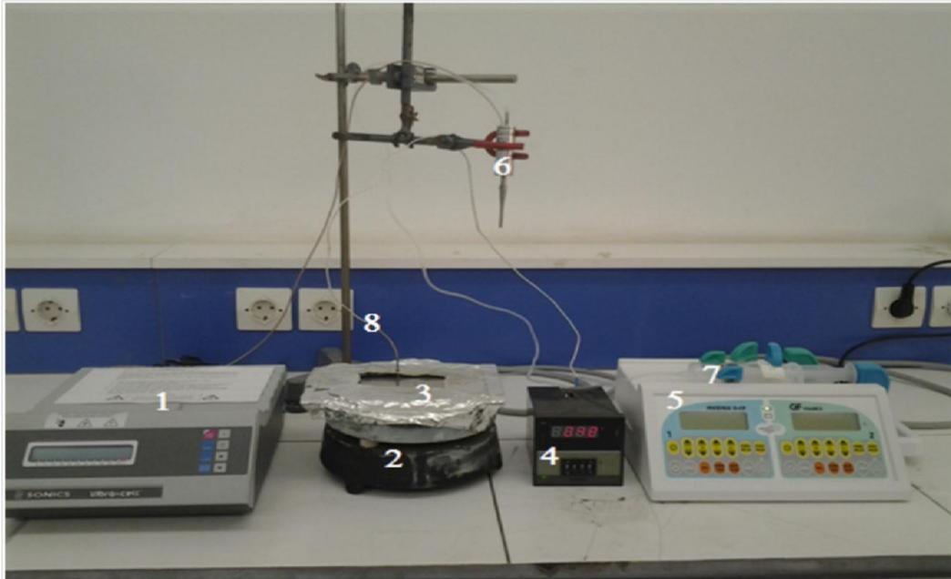
**Figure III.5** : schéma du banc de dépôt de couche mince par la technique spray pyrolyse ultrasonique.
