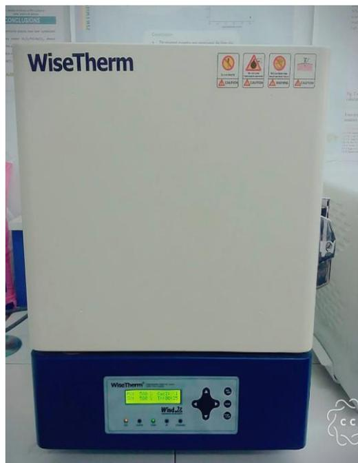
**Figure III.7 :** Four de recuit.
