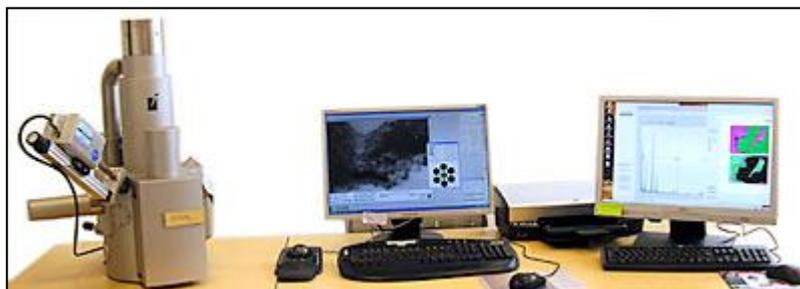
**Figure II.14 :** Dispositif Microscope Electronique à Balayage [21].
