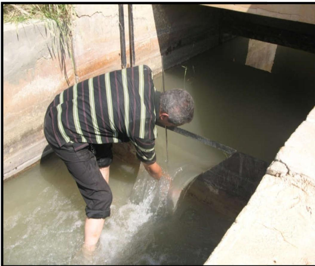
Figure III.9 : Déversoir triangulaire pour la mesure du débit du canal rive droite
