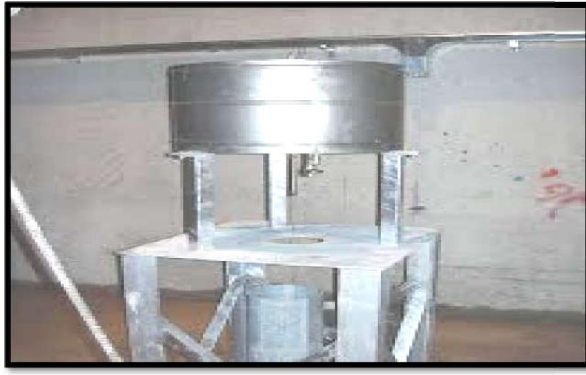
**Figure I.10 : Pendule inverse : La source : Sis geo.com**
