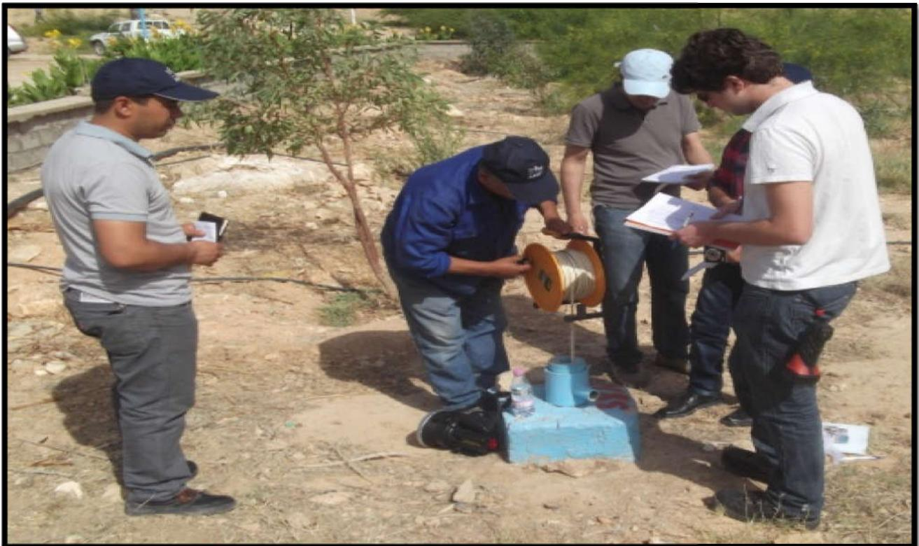
Figure II.13 : mesure la profondeur de piézomètre
