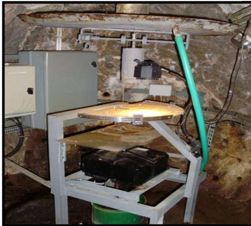
Figure I.09 : pendule direct : Source : (Photo Irstea - G2DR).
