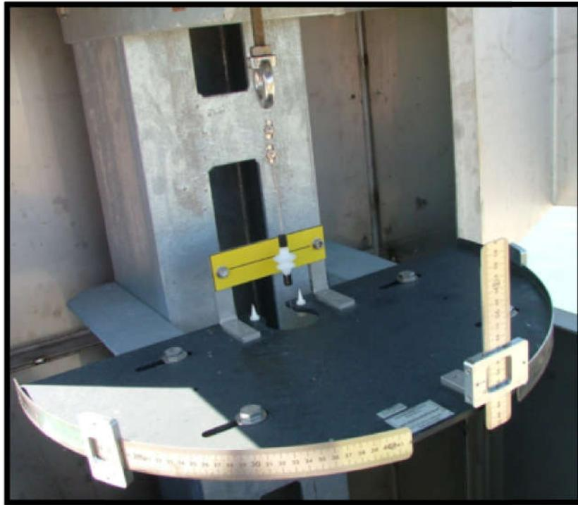
Figure I.8 : pendule avec mesure en Z. ; Source : (Photo G. Degoutte - Irstea - G2DR)
