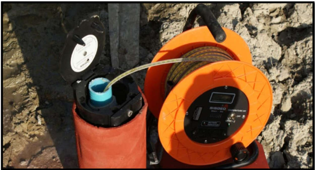
Figure III.5 : La sonde piézométrique, La source :(seisgeo.com)
