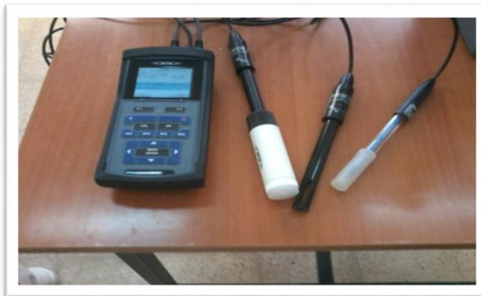
Figure n°11 : photo d'un multi paramètre
