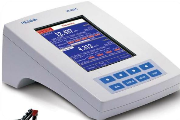
**Figure n°15 : Ionometre de Type « HANNA » de type HI 4521**
