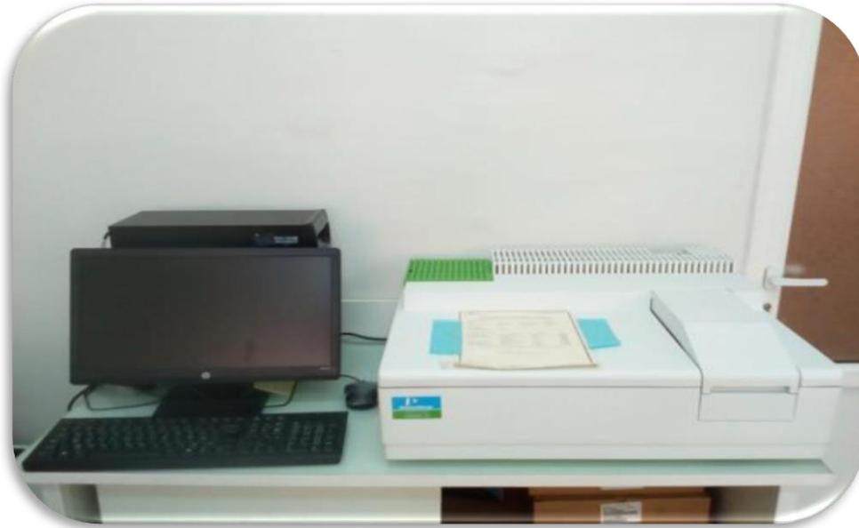
**Photo 14** : Spectrophotomètre UV- Visible.
