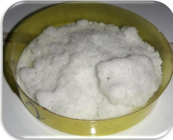
Photo 1 : Le sulfate d'aluminium en poudre.
