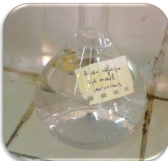
**Photo 12** : Solution d'acide sulfurique diluée à environ 2,2 moles/l.
