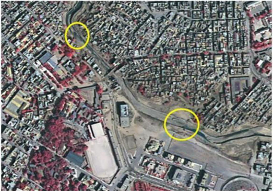
*Figure 2.19: Impacts de l'inondation identifiés sur les images du satellite Kompsat (©KARI), matérialisés par la destruction de deux passerelles (cercle en jaune).*
