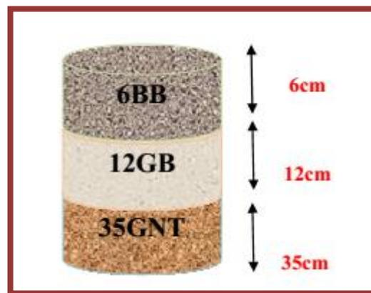
Figure VI -4 : différentes couches de la chaussée (CTTP)
