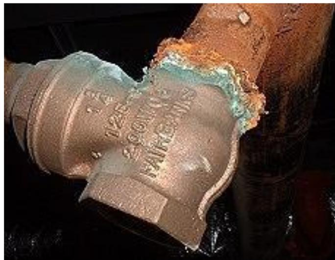
**Figure I.2 :** Corrosion galvanique [5].
