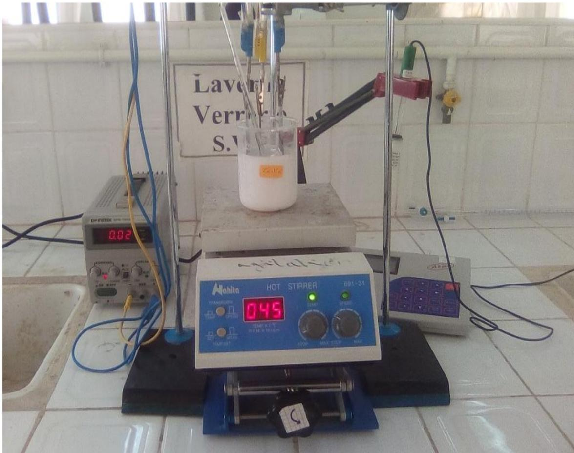
Figure III.17: Schéma de montage d'électrodéposition.
