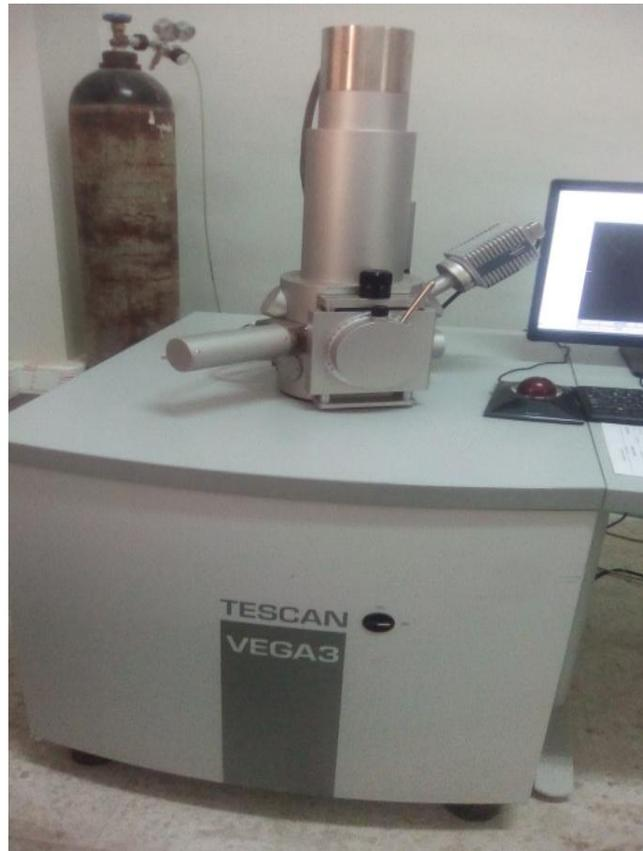
**Figure III.22:** Microscopie électronique à balayage (MEB).
