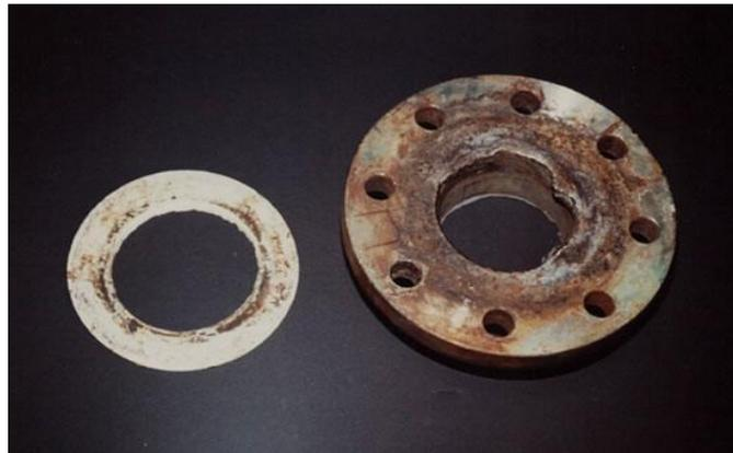
Figure I.3 : Corrosion caverneuse [5].
