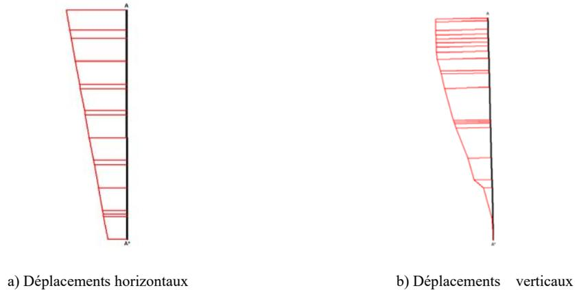
**Figure 3.9 :** Ligne de coupe des déplacements derrière le mur.
