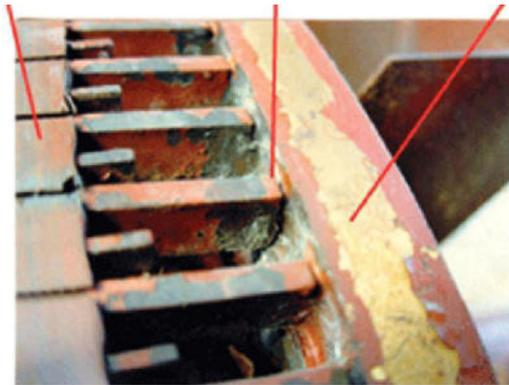
**Figure 1.6:** Exemple d'un défaut de cassure de barre d'un moteur asynchrone
