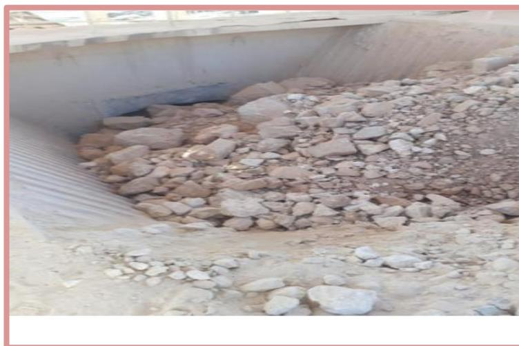
Figure I.3: Trémie de concasseur.
