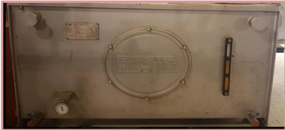
**Figure I.9:** Réservoir d'huile.
