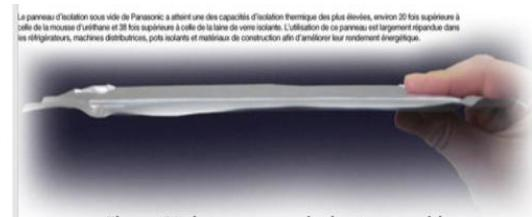
Figure 20: les panneaux isolants sous vide
