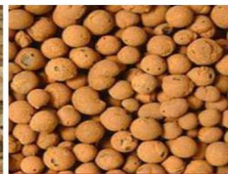
**Figure 12: l'argile expansée.**
