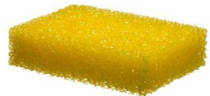
Figure 21: le polyuréthane (PUR).
