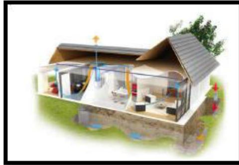
**Figure II- 28** : représentation simplifiée d'un puits canadien (source : G. Chanute – A ATLANTIC C)
