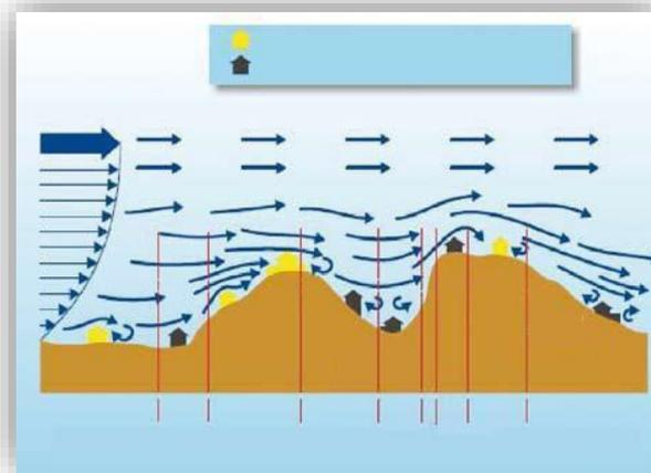
**Figure 2-10:** L'implantation en fonction du relief, des vents locaux
