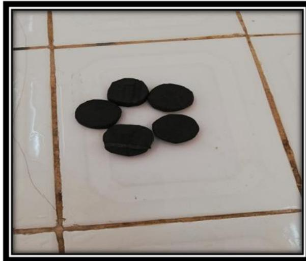
**Figure III-6:** Mis en forme des échantillons de pneu renforcé
