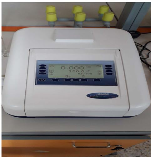
**Figure II-2 :** Spectrophotomètre visible JENWAY 7315.
