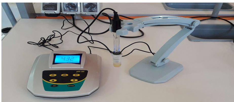
**Figure II-1 : pH-mètre de type HI 2210.**
