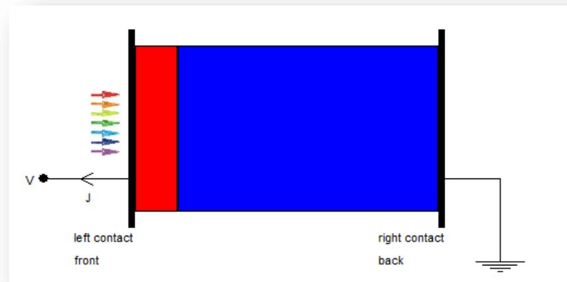
**Figure III.1:** Structure p-n de la cellule solaire en GaAs.
