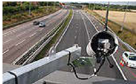
Figure 1.6. : Pips Technology : système de reconnaissance de plaque d'immatriculation. [LUD13]
