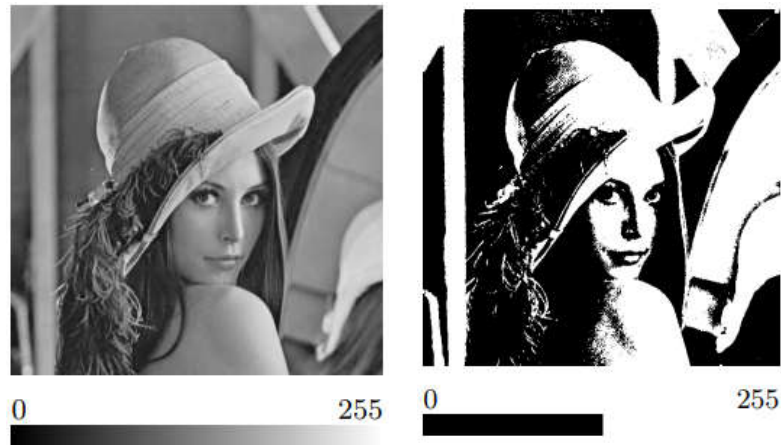
Figure 3.4. : Le seuillage permet de convertir une image de niveaux de gris vers noir et blanc. [MAZ18]
