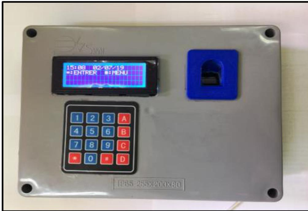
Fig. IV.15: Le dispositif électronique sur boîtier (externe)
