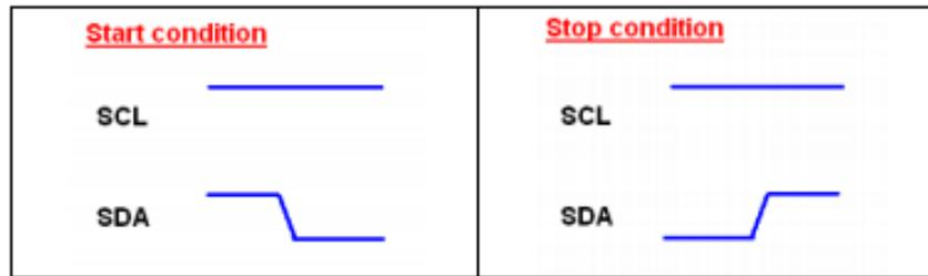
Les données sont envoyées par paquets de huit bits (ou octets). Le bit de poids fort est envoyé le premier, chaque octet est suivi par un bit d’acquittement (ACK) de la part du destinataire. Le processus fonctionne de la façon ci-dessous.
