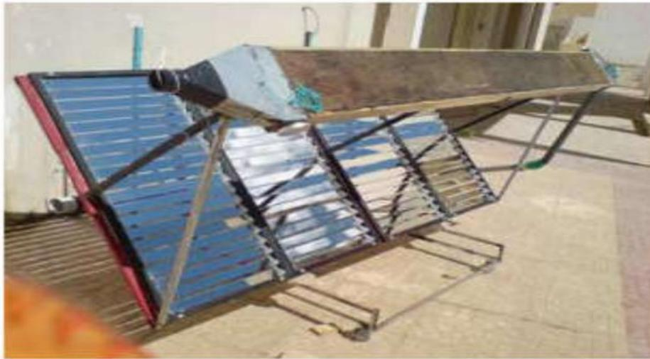
Figure. II.6. Capteur solaire à quatre éléments avec jeux de miroirs pivotants de type Fresnel [17].
