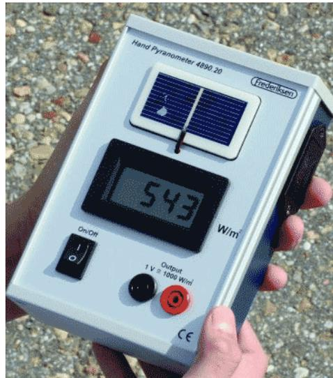
Figure III.10: Pyranomètre manuel
