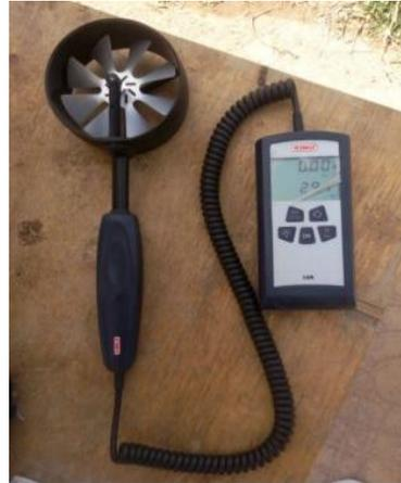
Figure. III.9 : Thermo-anémomètre à hélice
