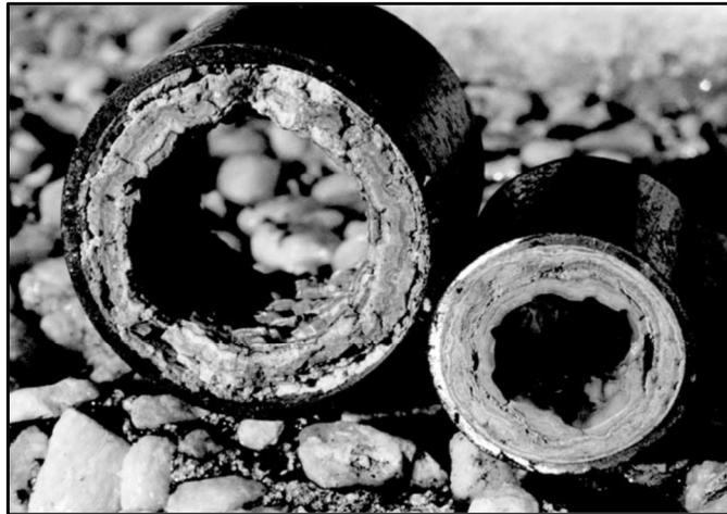
Figure 1.1 : Phénomène de précipitation « scale » d'un tubage de puits
